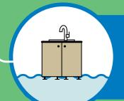
安裝採用抗洪材料 的櫥櫃並選用可拆 卸踢腳板。
